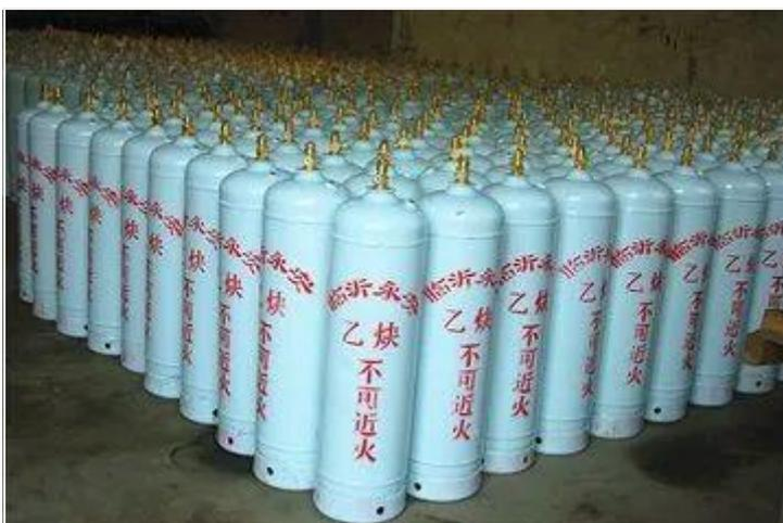
**原因 1：**乙炔瓶装填料和溶剂（丙酮），卧放使用时，丙酮易随乙炔气流出，不仅增加丙酮的消耗量，还会降低燃烧温度而影响使用，同时会产生回火而引发乙炔瓶爆炸事故。
