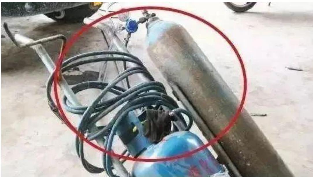
▲氧气瓶和液压罐使用状态下距离不足 5 米，氧气减压器压力表损坏失效，胶管未区分，
