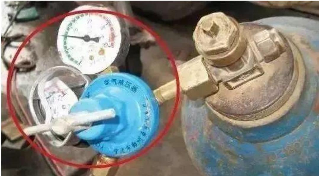
▲氧气减压器失效破裂，可能造成氧气胶管爆裂，发生火灾事故。
