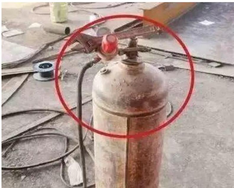
▲乙炔减压器未安装回火防止器，气瓶未采取防倾倒措施，颜色不符合标准要求的白色，可能造成火灾、容器爆炸事故。
