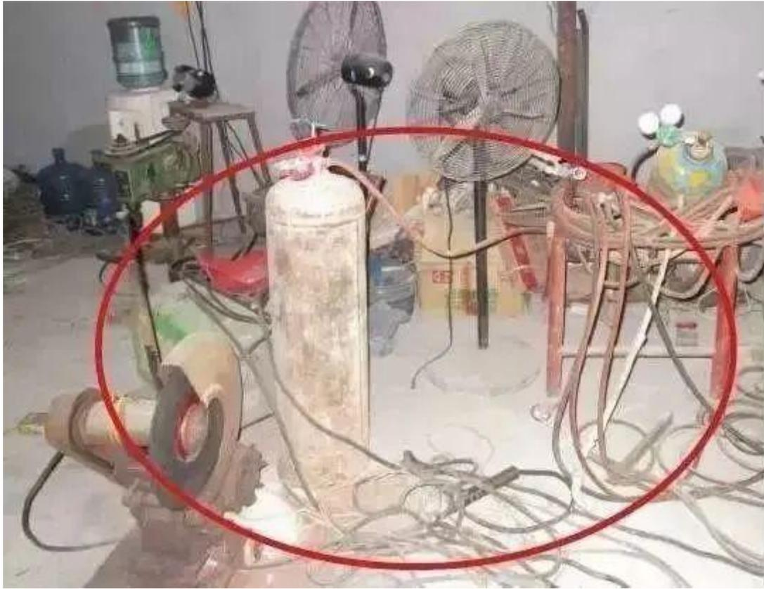
▲氧气瓶使用的胶管错误，氧气应采用蓝色胶管。氧气瓶与乙炔气瓶距离不足5米，乙炔瓶离产生火花的设备砂轮切割机太近，可能造成容器爆炸事故。
