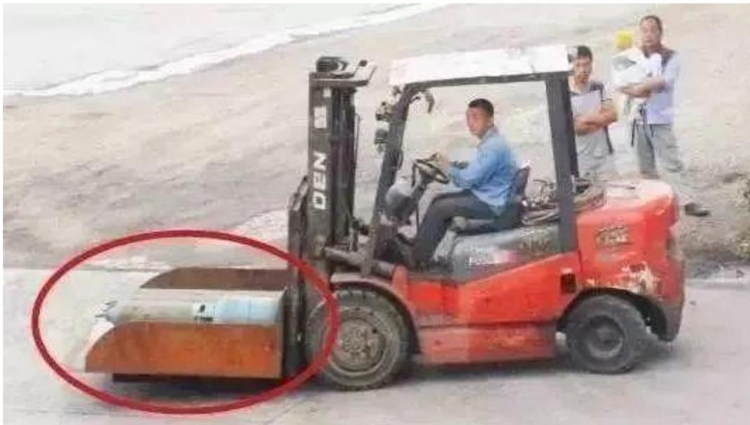
▲氧气瓶、液化罐混装叉车运输，氧气瓶两圈一帽缺失，可能造成容器爆炸事故。
