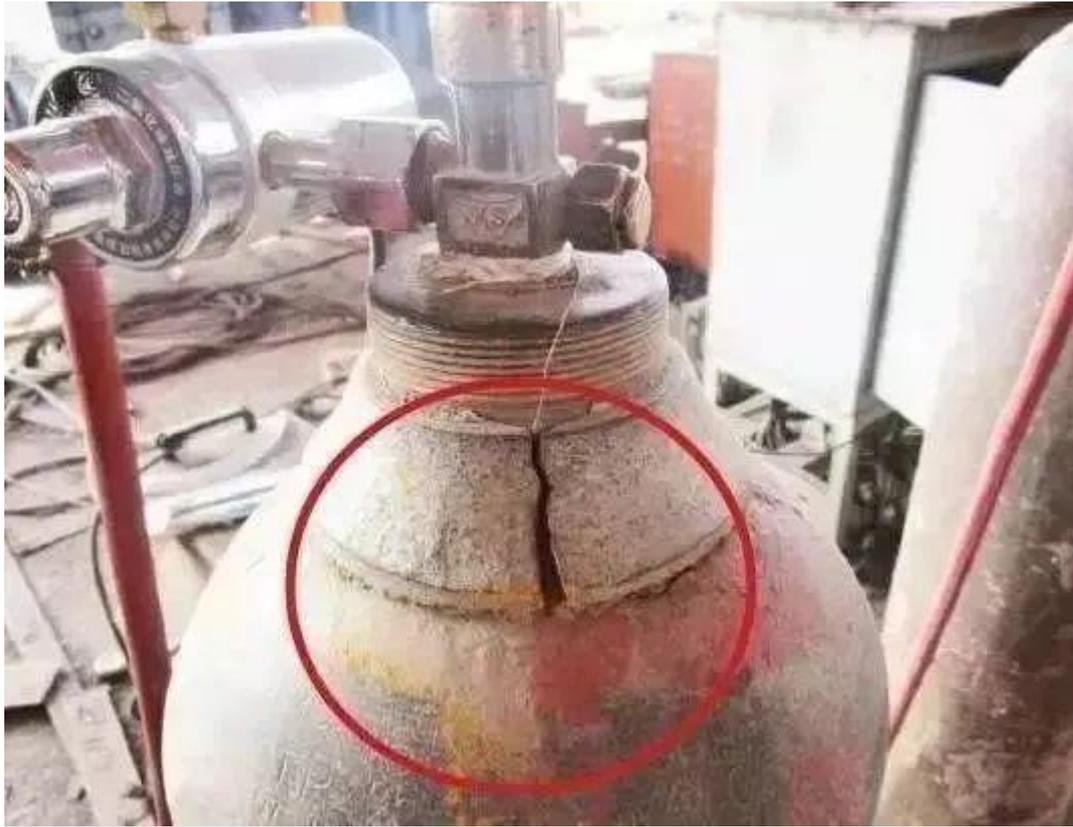
▲CO2 气瓶颈破裂，钢印模糊不清，怀疑使用残废瓶，可能造成容器爆炸事故。
