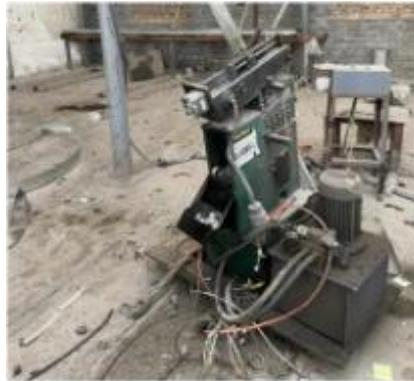
图1 现场使用的高频焊机
