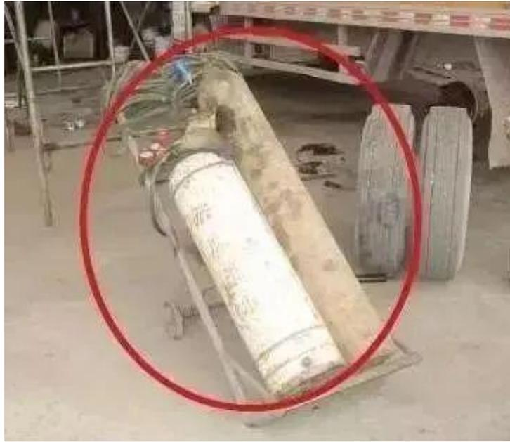
▲氧气、乙炔胶管使用同一种颜色胶管，未区分，存放状态下两瓶之间安全距离不足。
