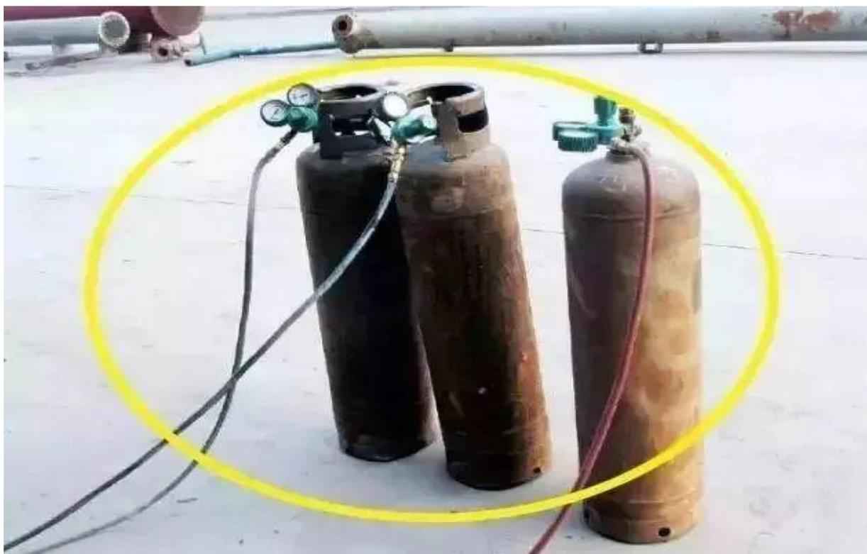
▲气瓶无防护圈，无防倒设置，瓶体颜色缺失，同一种气瓶管线颜色不同。
