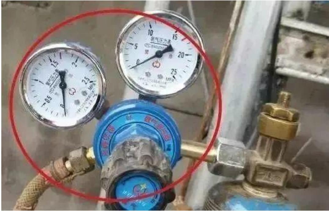
▲氧气减压器压力表未校验，氧气胶管胶皮剥落，胶管扎头未采用标准管夹，可能造成火灾、容器爆炸事故。
